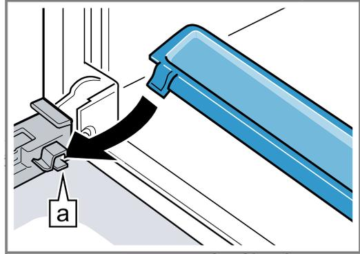
3. Desplazar el cristal intermedio en la sujeción izquierda y derecha [a].
