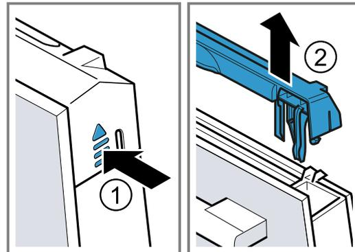
6. Extraer el cristal interior ① y depositarlo con cuidado sobre una superficie plana.
