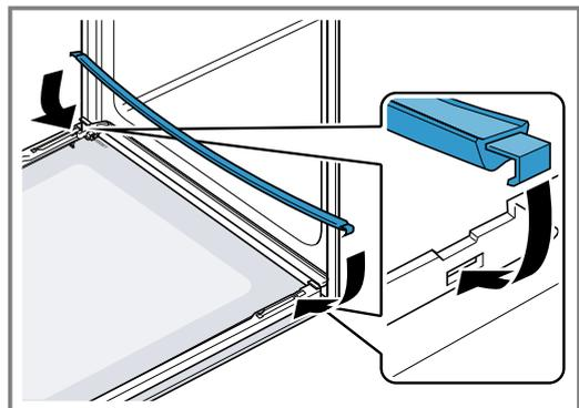
6. **Nota:** Al introducir los cristales de la puerta, asegurarse de que la parte brillante del cristal esté en el exterior y de que las muescas, a derecha e izquierda, queden arriba.
