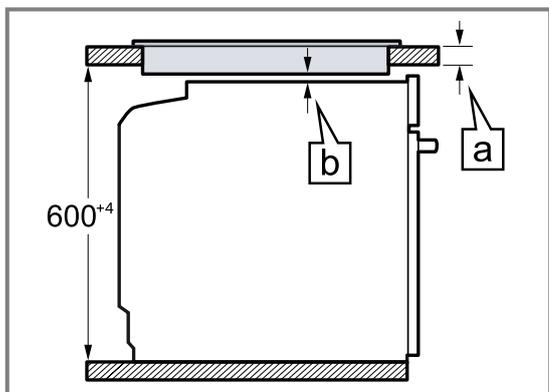
En función de la separación mínima requerida  $\text{[b]}$  se determina el grosor mínimo de la encimera  $\text{[a]}$ .
