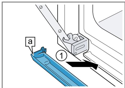
2. Encajar los ganchos **a** de la bandeja recogedora del agua de condensación a izquierda y derecha de la separación ①.
