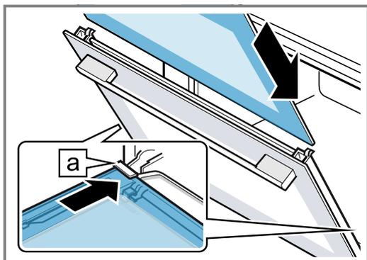
7. Presionar el cristal interior por arriba hasta que quede en las sujeciones izquierda y derecha [a].
