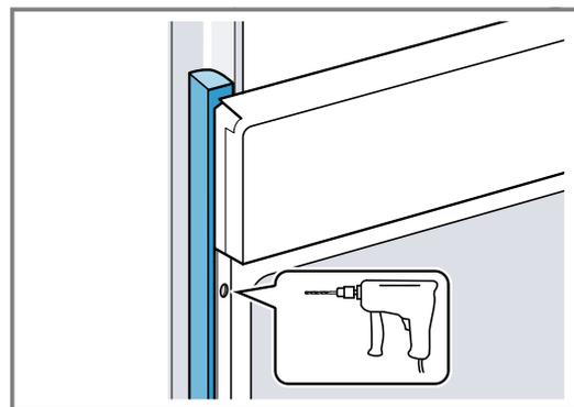
3. Fijar el aparato con los tornillos adecuados.
