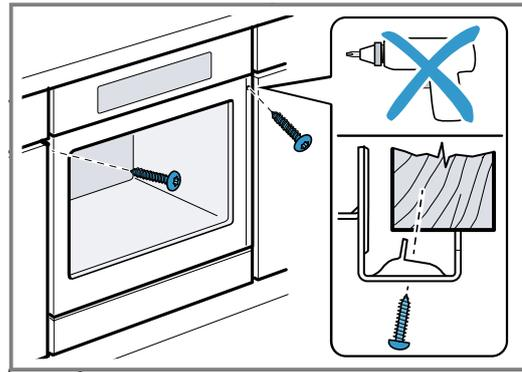
**Nota:** El espacio entre la encimera y el aparato no debe obstruirse con listones suplementarios. En las paredes laterales del armario desmontable no se pueden montar listones térmicos.
