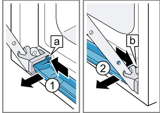
3. Inclinar la bandeja recogedora del agua de condensación ligeramente hacia delante hasta que se suelte el gancho de soporte inferior.
