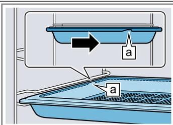
3. Introducir completamente el accesorio de manera que no toque la puerta del aparato.
