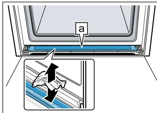
Absorber el líquido de la bandeja de recogida de agua de condensación
