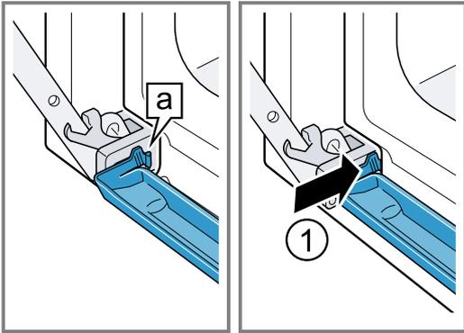
3. Presionar la bandeja recogedora del agua de condensación hasta que encajen los ganchos a izquierda, derecha e inferior.
