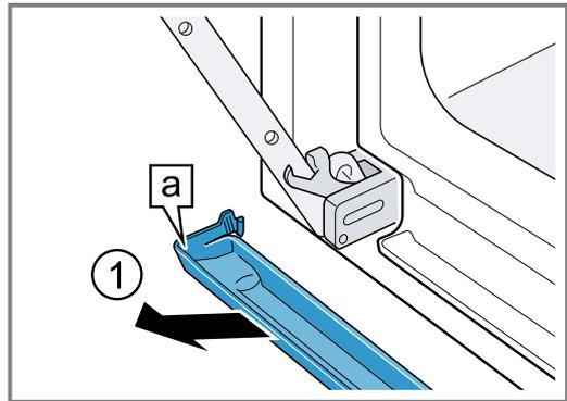
**Montar la bandeja recogedora del agua de condensación**
