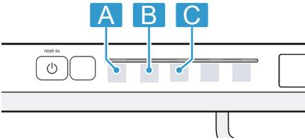
Cuando el LED A está encendido, la función está desactivada de manera permanente.
