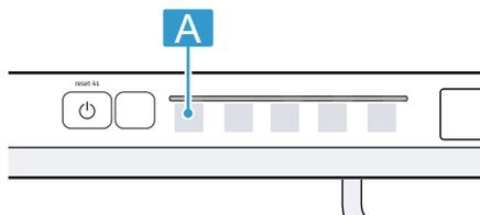
Cuando el LED A no está encendido, la conexión de red inalámbrica está desactivada.
