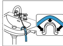
Fijar y asegurar la manguera de desagüe con un racor en codo.
