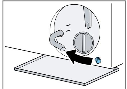
1. Sujetar el tubo de drenaje a la sujeción.
