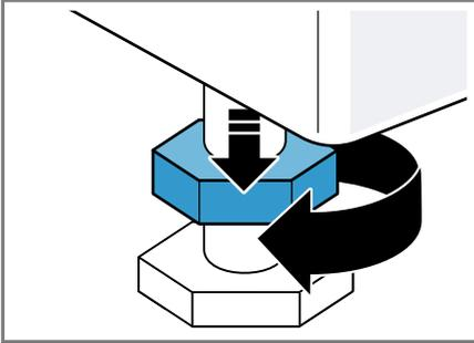
2. Girar las patas del aparato para nivelarlo. Comprobar la nivelación con un nivelador de agua.
