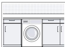
Colocar el aparato solo bajo una encimera de trabajo bien unida a los muebles adyacentes. Ancho del hueco requerido: 60 cm.
