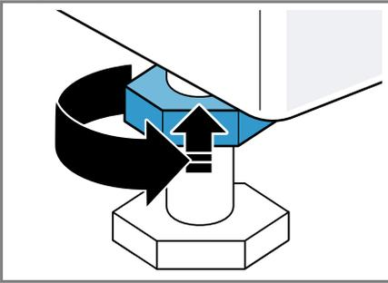
Sujetar a tal efecto las patas del aparato sin modificar su altura.
