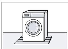
Colocar el aparato sobre una tabla resistente al agua (mín. de 30 mm de grosor) que esté firmemente atornillada al suelo.
