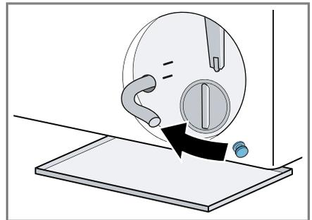
9. Sujetar el tubo de drenaje a la succión.
