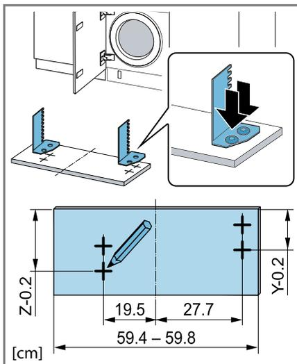
4. Montar la placa protectora del zócalo.
