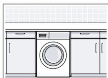
Colocar el aparato solo bajo una encimera de trabajo bien unida a los muebles adyacentes. Ancho del hueco requerido: 60 cm.
