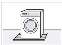
Colocar el aparato sobre una tabla de madera resistente al agua (mín. de 30 mm de grosor) que esté firmemente atornillada al suelo.
