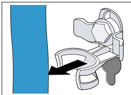
2. Aflojar ① y retirar ② todos los tornillos de los cuatro seguros de transporte con una llave de tuercas de apertura 13.
