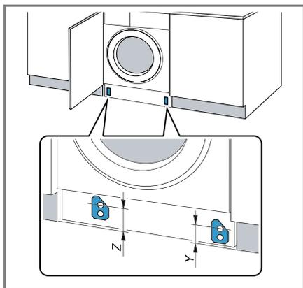
3. Atornillar el tope de deslizamiento de modo acorde con las medidas.
