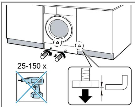
8. Nivelar el aparato con un nivelador de agua.
