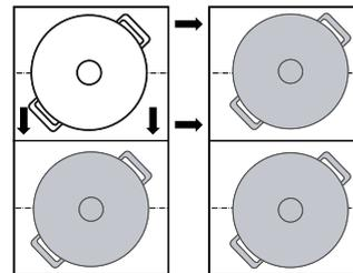
El recipiente es detectado y en el indicador de la nueva zona de cocción parpadean alternativamente el nivel de potencia y  $\mathcal{L}a$ .
