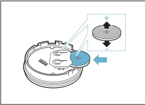
**Nota:** No usar objetos metálicos para quitar la batería. No tocar la zona de bornes de contacto de la batería.
