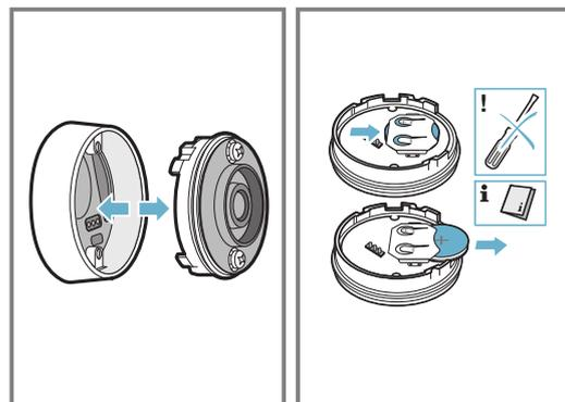
3. Colocar la nueva batería (seguir las instrucciones de polaridad de la batería). Utilizar solo baterías de tipo CR2032, de buena calidad.
