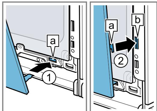
6. Presionar el cristal delantero por abajo ① hasta que se oiga que ha encajado.
