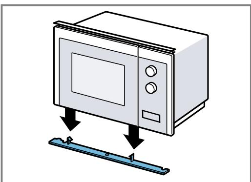
3. Atornillar el tornillo central de la base del microondas.
