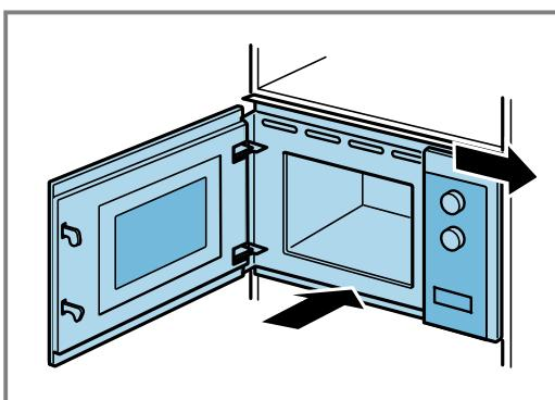
**3. Atornillar el aparato hasta que quede en posición central.**
