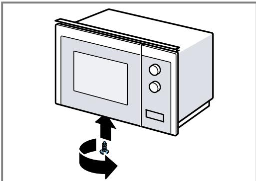
4. Solte os 2 parafusos exteriores no fundo do micro-ondas.
