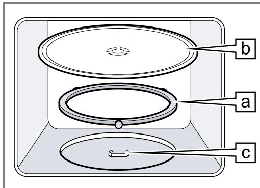
2. Ασφαλίστε τον περιστρεφόμενο δίσκο **b** στον μηχανισμό κίνησης **c** στη μέση του πάτου του χώρου μαγειρέματος.
