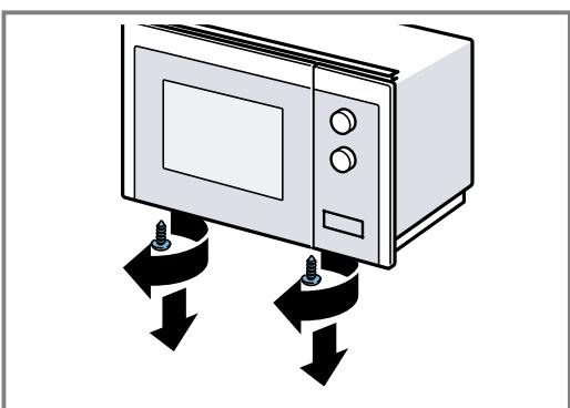
5. Fijar el marco de integración en la base del microondas con los dos tornillos exteriores.
