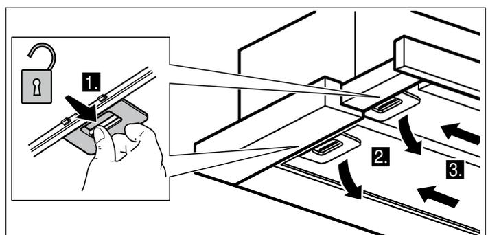
**Nota:** La grasa puede acumularse en la parte inferior del filtro metálico antigrasa. Sujetar el filtro metálico antigrasa en posición horizontal para evitar que gotee grasa.
