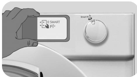
Nous vous suggérons de finaliser la procédure d'enregistrement de votre appareil via WIFI avant d'installer l'appareil dans son emplacement définitif.
