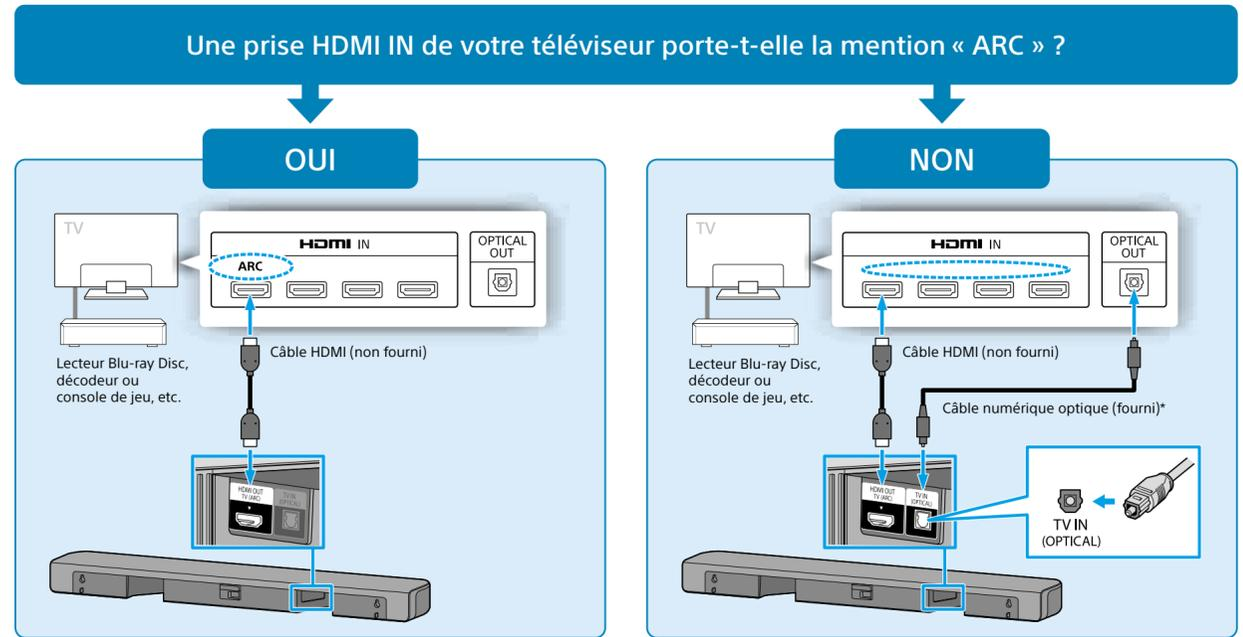
\* Si votre téléviseur ne prend pas en charge la fonction ARC (Audio Return Channel), connectez un câble numérique optique (fourni) pour écouter le son du téléviseur.
