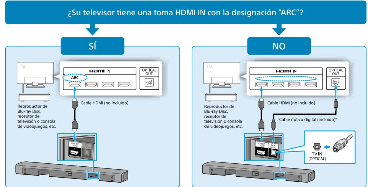
\* Si su televisor no es compatible con la función ARC (Audio Return Channel), conecte un cable óptico digital (incluido) para escuchar el sonido del televisor.
