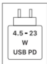
A3287/A3293: La potencia suministrada por el cargador debe estar entre los 4,5 vatios mínimos requeridos por el equipo de radio y los 23,0 vatios máximos para conseguir la máxima velocidad de carga.
