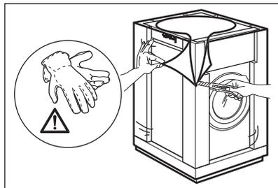
2. Retire la cubierta de cartón y los materiales del embalaje de poliestireno.
