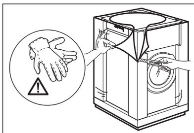
2. Retire la cubierta de cartón y los materiales del embalaje de poliestireno.
