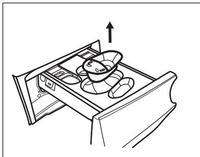
3. Levanta la cubierta superior de los compartimentos para extraerla.
