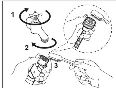
2. Retire la manguera de entrada del aparato aflojando la tuerca anular.
