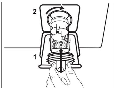
9. Vuelva a colocar el filtro en las guías especiales girándolo hacia la derecha. Asegúrese de que aprieta el filtro correctamente para evitar fugas.
