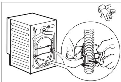
5. Retire el cable de alimentación y el tubo de desagüe de los soportes de los tubos.
