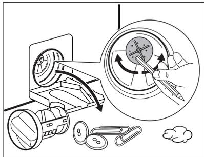
7. Si fuera necesario, retire las pelusas y objetos del hueco del filtro. Asegúrese de que el rotor de la bomba gira. Si no es así, póngase en contacto con el servicio técnico autorizado.
