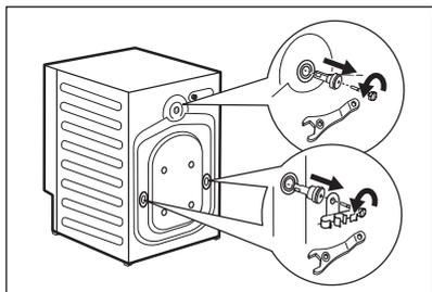
6. Suelte los tres pernos, los soportes de la manguera y los separadores de plástico con la llave suministrada con el aparato.
