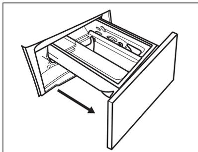
2. Retire la parte superior del compartimento de aditivo para ayudar a limpiarlo y enjuáguelo con agua templada para eliminar restos de detergente acumulado. Después de limpiarlo, vuelva a colocar la parte superior en su sitio.
